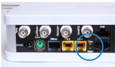
Auf der Gehäuserückseite der *Expansion Box 2* befinden sich zwei Status-LEDs, die über die *PAB*-Kommunikation Aufschluss geben.
