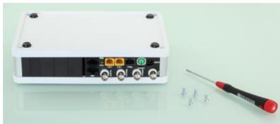
Drehen Sie die *Expansion Box 2* auf den Kopf und lösen Sie vorsichtig die 4 Inbus-Schrauben in den 4 Ecken der Gehäusebodenplatte. Ziehen Sie Schrauben heraus und drehen Sie das Gehäuse zusammen mit dem Boden wieder herum.
