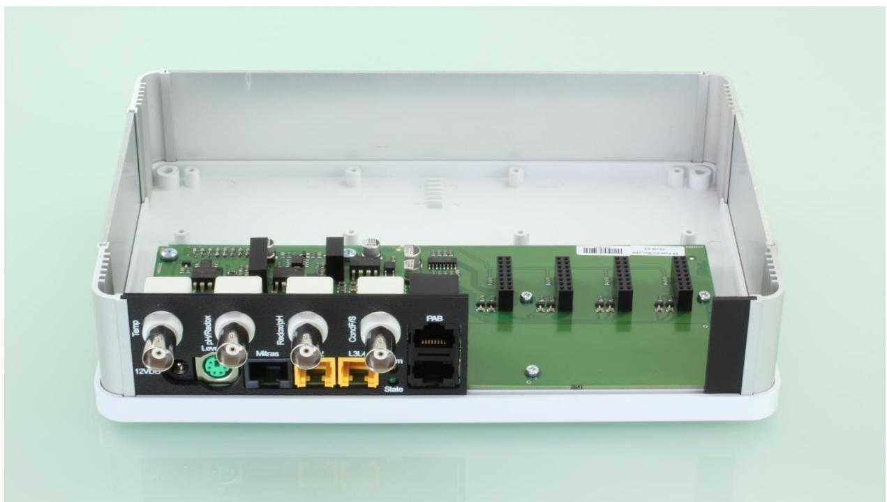
Rechts sind die freien Steckplätze zum Einsticken der Module zu sehen, links daneben befinden sich die werkseitig bereits eingebauten Anschlüsse.
