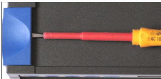
Nachdem alle Abdeckkappen entfernt wurden ist die obere Gehäusehälfte abzunehmen. Das Gehäuse ist nur zusammengesteckt, durch Lösen der 4 Rastnasen kann das Gehäuse geöffnet werden. Am einfachsten geht dies, indem ein runder, ca. 5mm durchmessender Gegenstand von oben in die Gehäuseverriegelung geschoben wird. Auf nachfolgendem Bild wurde hierzu ein Schraubendreher verwendet.
