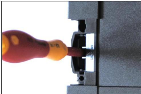
Besonders einfach geht es, wenn mindestens 2 Gehäuseverriegelungen gleichzeitig gelöst werden. Beim vorsichtigen und langsamen Abheben des oberen Gehäusedeckels darauf achten, dass die Frontplatte und die Rückplatte im unteren Gehäusedeckel bleiben!
