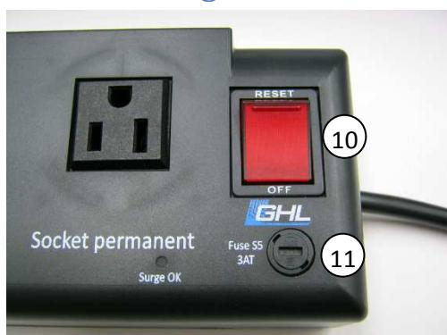
Alle Steckdosen sind über einen beleuchteten Schalter (10) mit Sicherungsfunktion (UK-Modell ohne Sicherungsfunktion) geführt. Bei Überlastung der *Powerbar5.1-PAB* schaltet dieser Sicherungsschalter ab. Bei Auslösen des Sicherungsschalters, kann der Schalter einfach wieder eingeschaltet werden, wenn die Überlast entfernt wurde. Beim UK Modell ist der Überlastschutz durch die Absicherung der Steckdose gegeben.
