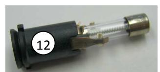
Der Sicherungseinsatz federt dann nach außen. Die defekte Sicherung im Sicherungseinsatz (12) wird dann durch die neue Sicherung ersetzt. Danach den Sicherungseinsatz wieder einsetzen (auf die Führungsnasen achten!) und mit leichtem Druck nach innen und gleichzeitigem Drehen um ca. 45° im Uhrzeigersinn verriegeln.
