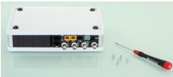
turno *ProfilLUX 4* a testa in giù e con attenzione svitare le 4 viti a brugola nei 4 angoli della piastra inferiore dell'alloggiamento. Tirare le viti fuori e invertire la custodia insieme alla piastra inferiore di nuovo.
