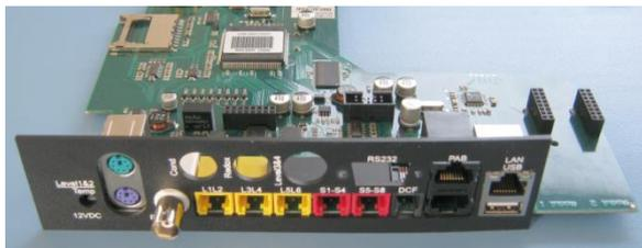
Heben Sie die Hauptplatine zusammen mit der schwarzen Rückplatte heraus und tauschen Sie die alte Rückplatte gegen die neue Rückplatte.
